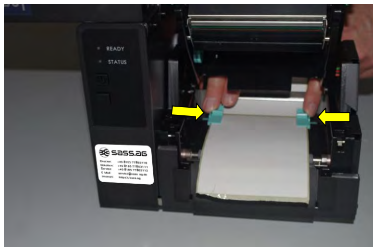
Abb. 4.3.1.p Papierführungen vorsichtig an das Material heranschieben
