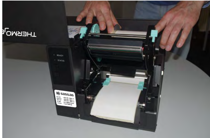
Abb. 4.3.1.q „Alle“ Teile zusammen seitlich verschieben (d.h. Materialrolle samt den Spacern und den 2 Zentrierhülsen)
