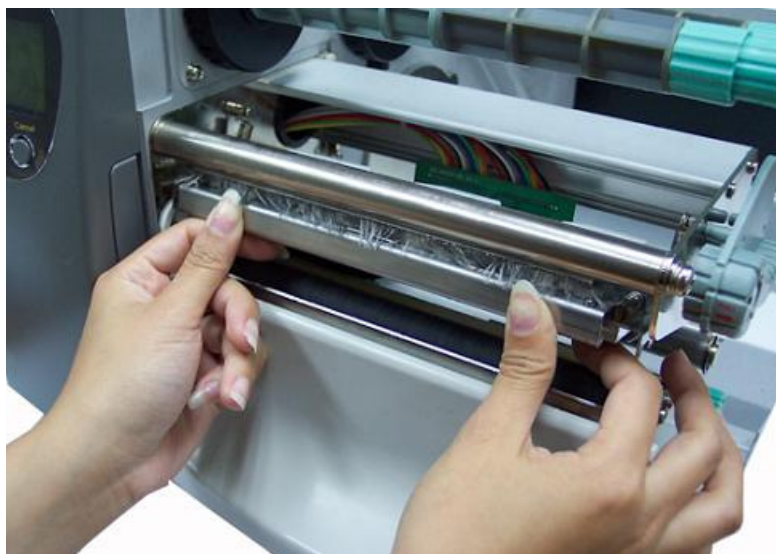
Abb. 9.2.1.f Druckkopf ganz in die Halterung einführen
