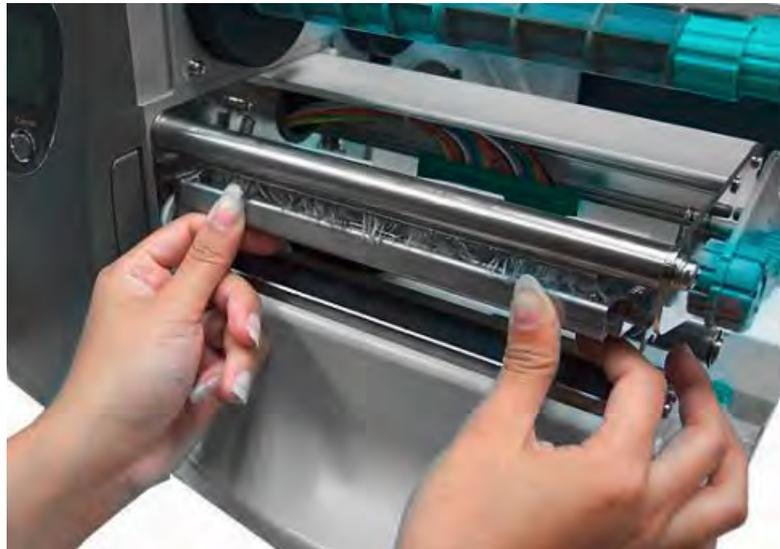
Abb. 9.2.1.f Druckkopf ganz in die Halterung einführen
