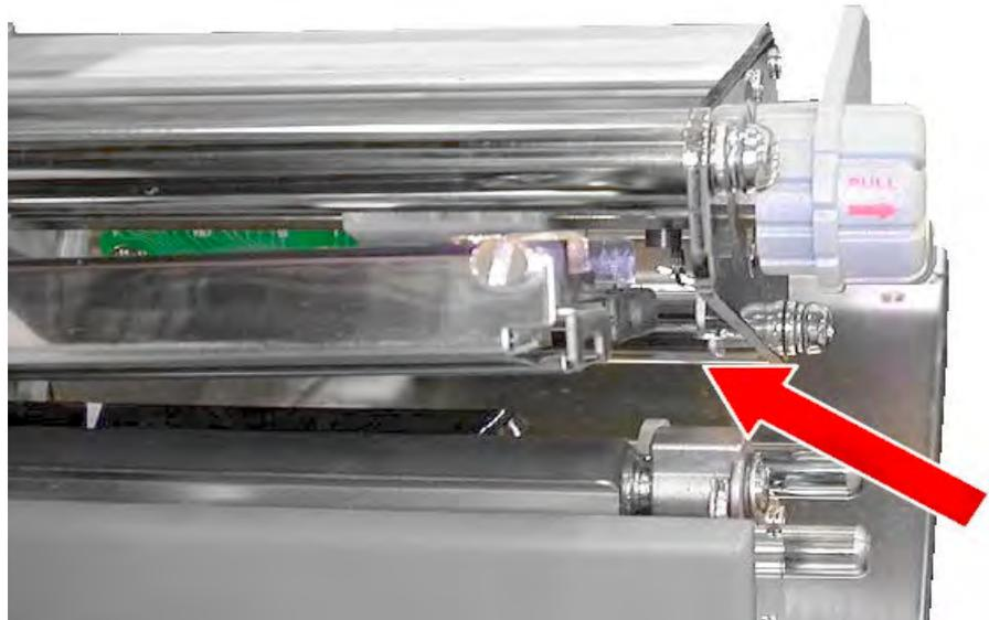
Abb. 9.2.1.d Druckkopf in seitliche Führungen einführen
