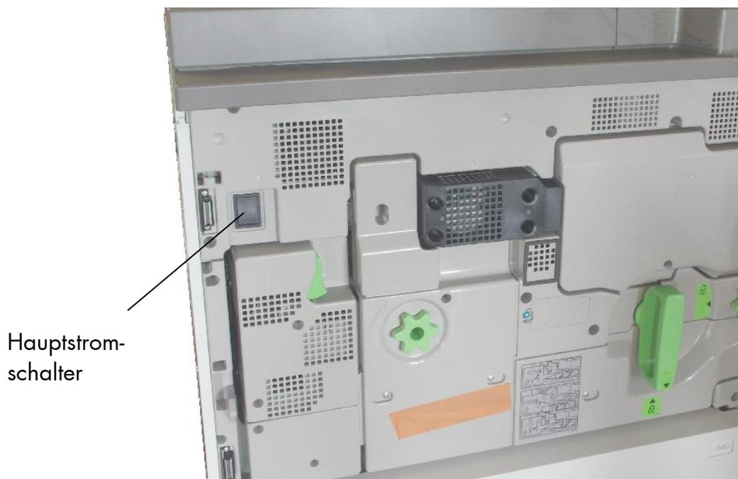
Abb. 4.2.b Hauptstromschalter (Netzschalter) des Druckers einschalten
