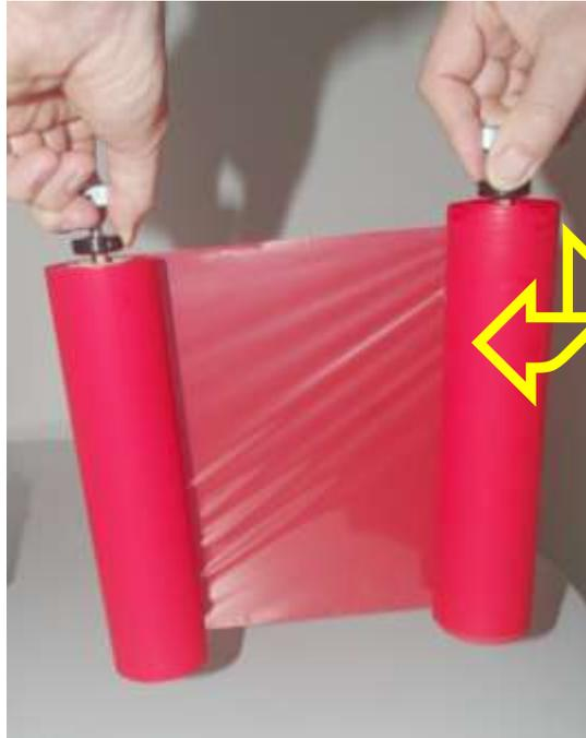
Abb. 5.2.4.f Freies Ende des Farbbandes aufwickeln
