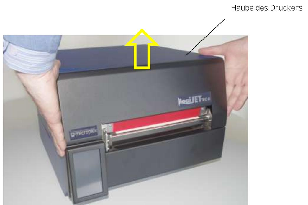
Abb. 2.4.c Haube des Druckers öffnen
