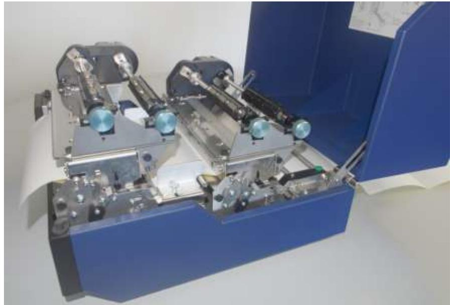
Abb. 5.1.1.k Beide Druckkopfeinheiten sind wieder nach unten geschwenkt und verriegelt
