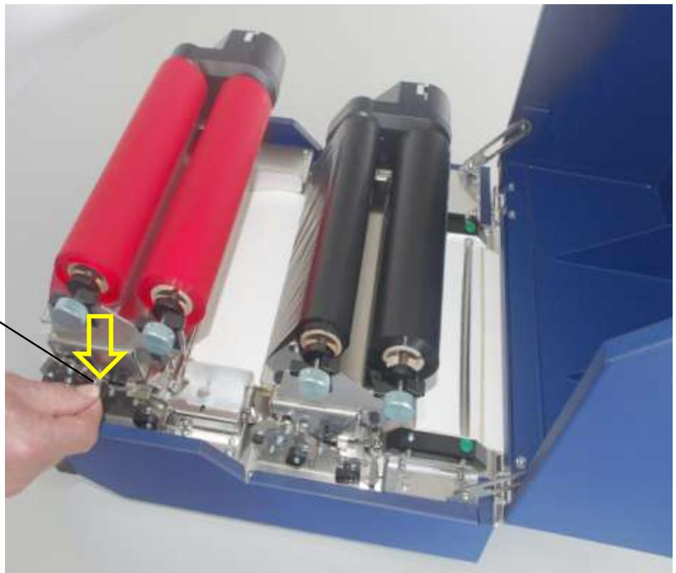
Abb. 5.2.4.a Vordere Druckkopfeinheit entriegeln
