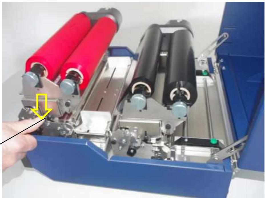
Hebel zum Entriegeln der Druckkopfeinheit
