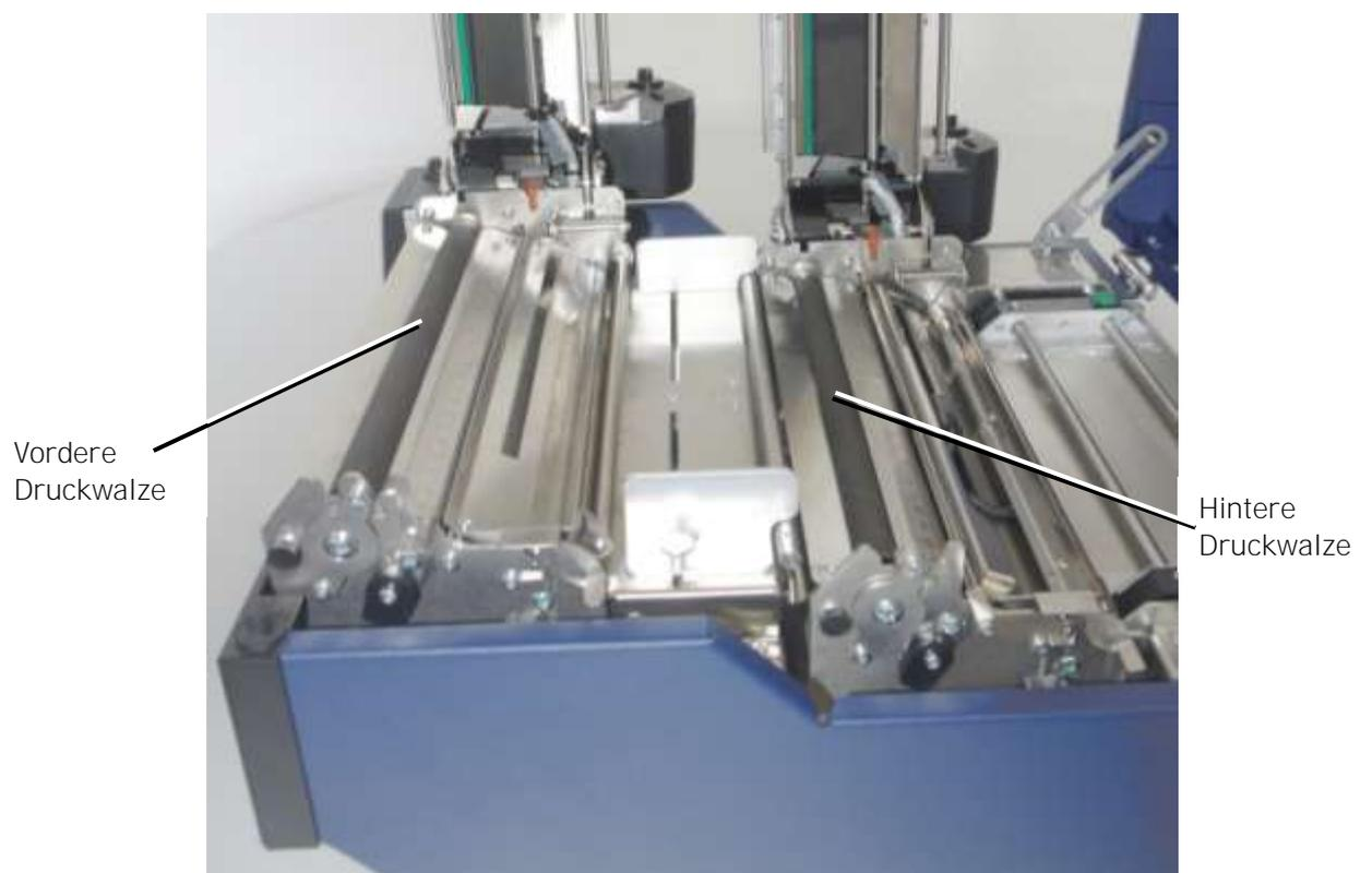
Abb. 8.1.3.c Position der Druckwalzen
